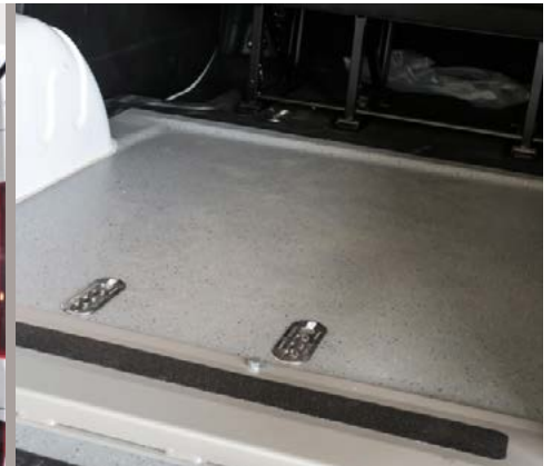
Retapizado de suelo Tarabus , en la zona destinada a la persona en silla de ruedas. Anclajes de suelo empotrados para facilitar el acceso.
