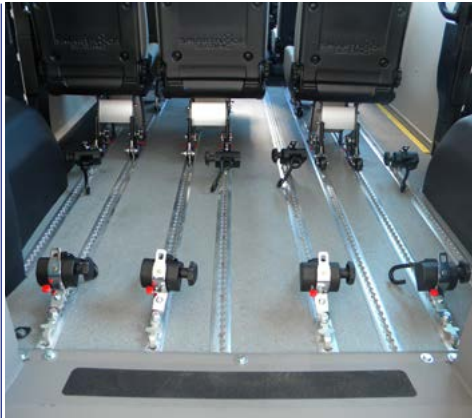
El suelo Smartfloor dota al vehículo de flexibilidad en las configuraciones, y se combina con el sistema de seguridad PROTEKTOR para sujetar la silla.
