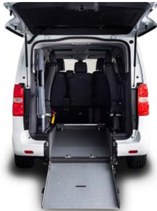
Rebaje de Piso con rampa de acceso manual. Ligera y resistente con capacidad de carga de hasta 350 Kg. Se mantiene el depósito de combustible original.
