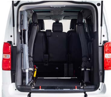
El sistema Eaxyflex permite abatir la rampa para aprovechar toda la capacidad del maletero o utilizar los 2 asientos opcionales en 3ª fila.
