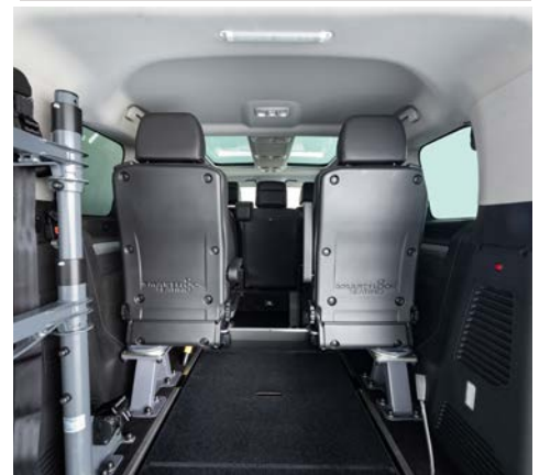
Los asientos opcionales de tercera fila , aumentan la capacidad del vehículo de 5 plazas+silla a 7 plazas.
