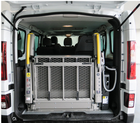
Plataforma elevadora Panorama AL1 1200 . Capacidad de carga 400 kg. Plato plegable en dos partes con una longitud total de 1200 mm.
