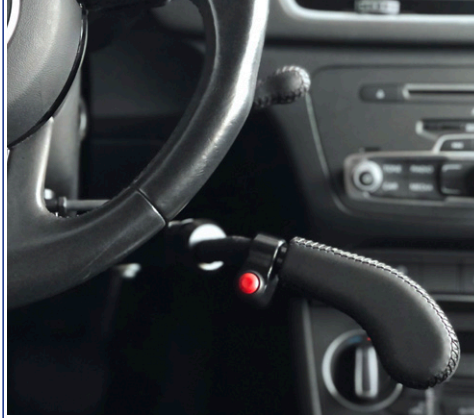
Freno al volante: frenado manual por presión horizontal sobre el mando.
