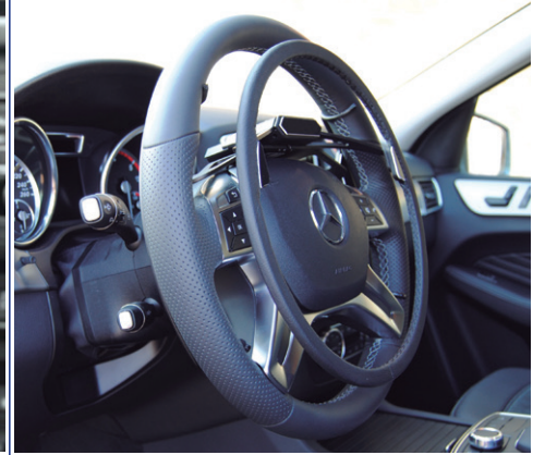
Acelerador de aro: aceleración suave por presión del aro situado en el volante.
