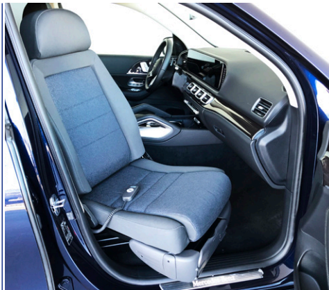
Asiento giratorio: permite la integración en el vehículo como pasajero o conductor.
