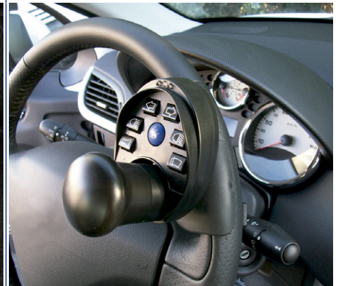
Satélite multifunción: panel que acciona hasta 12 funciones .
