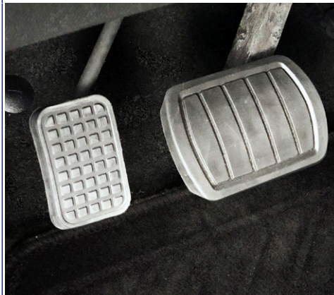
Acelerador de pie izquierdo: pedal desmontable para la aceleración.
