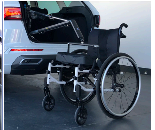
Grúa: permite introducir en el vehículo carritos y sillas de ruedas de manera sencilla.
