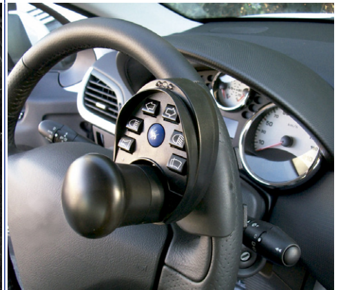
Satélite multifunción: panel que acciona hasta 12 funciones.
