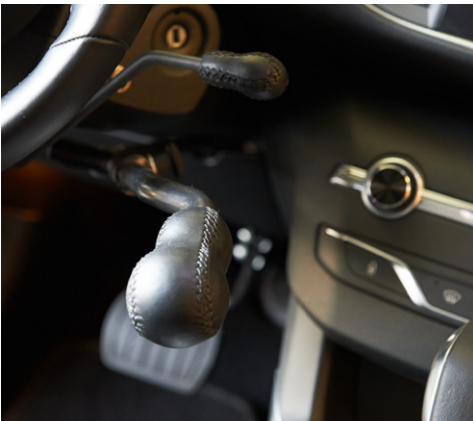
Acelerador de levas: situadas a los lados del volante. Aceleración suave.
