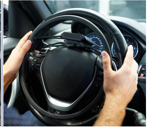
Acelerador de aro: aceleración suave por presión del aro situado en el volante.
