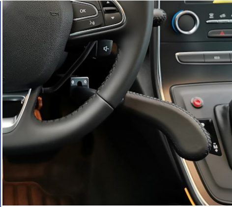
Freno al volante: frenado manual por presión horizontal sobre el mando.
