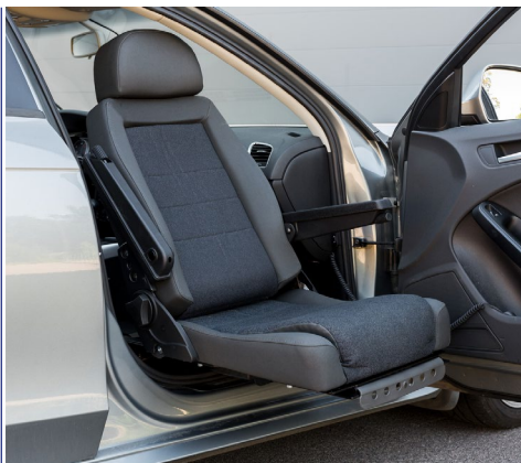
Asiento giratorio: permite la integración en el vehículo como pasajero o conductor.
