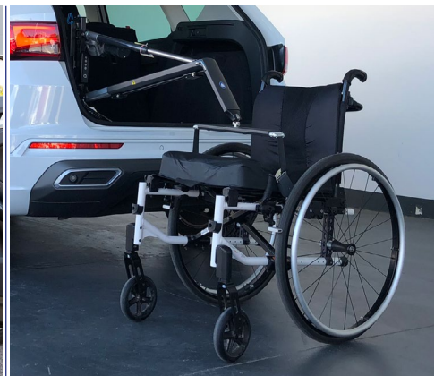
Grúa: permite introducir en el vehículo carritos y sillas de ruedas de manera sencilla.
