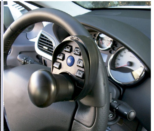
Satélite multifunción: panel que acciona hasta 12 funciones .
