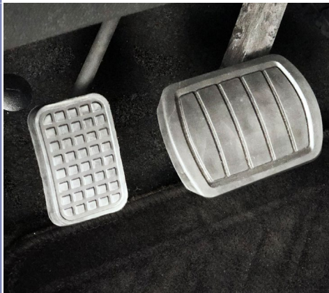
Acelerador de pie izquierdo: pedal desmontable para la aceleración.
