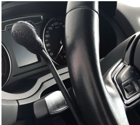
Accelerador de levas: situadas a los lados del volante. Aceleración suave.
