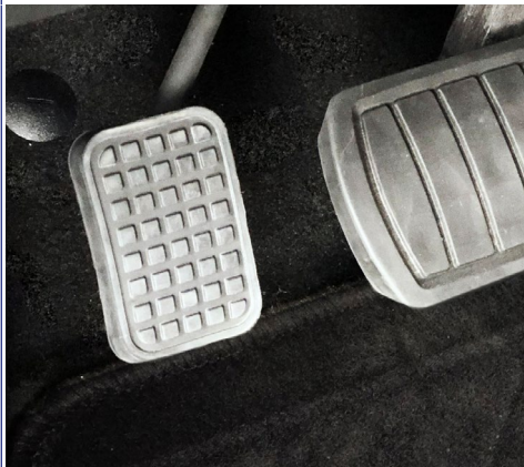
Accelerador de pie izquierdo: pedal desmontable para la aceleración.
