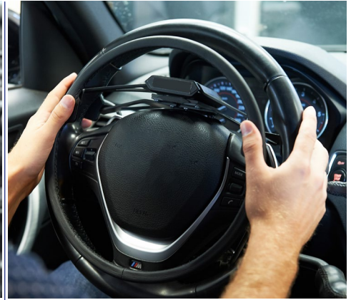
Accelerador de aro: aceleración suave por presión del aro situado en el volante.
